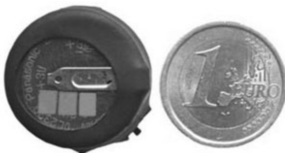
9-расм. Танга кўринишидаги радиоўрнашма.
