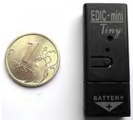
11-расм. Edic-Mini Tiny B21 русумли мини-диктофон.
