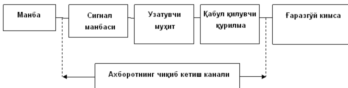
1-расм. Ахборотнинг чиқиб кетиш техник канали тузилиши
