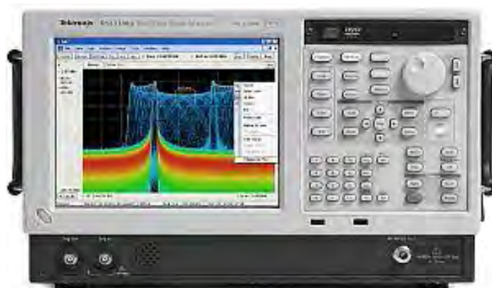
6-расм. RSA5103A русумли спектр анализатори.
