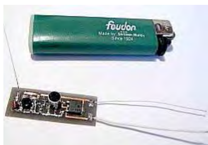
8-расм. Зажигалка кўринишидаги радиоўрнашма.
