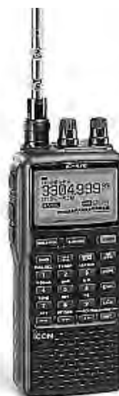
IC-R20 русумидаги портатив сканерловчи приёмник.
