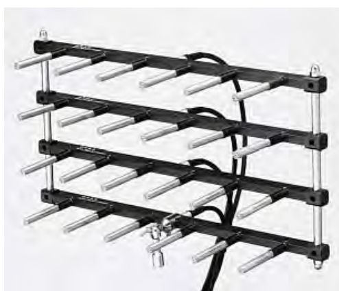
16-расм. G.R.A.S. фирмасининг ясси микрофони.
